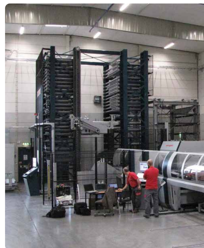
Magazzino automatico per stoccaggio pacchi di lamiera su vassoio (sette settore meccanico)
