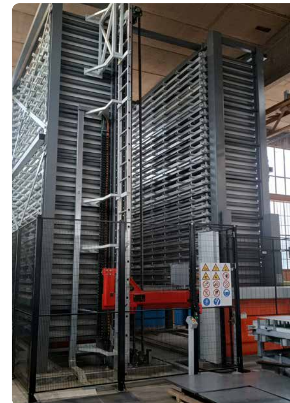
Magazzino automatico per stoccaggio lamiera su vassoio
