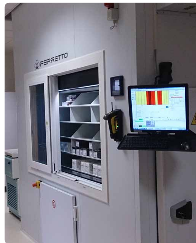
Magazzini rotanti a temperatura controllata (Settore Ospedaliero)
