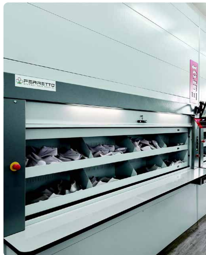
Magazzini rotanti da industria (Settore Calzaturiero)
