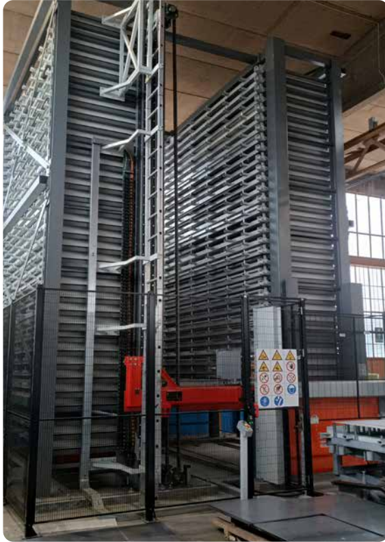
Almacén automático para almacenamiento de chapas en bandejas
