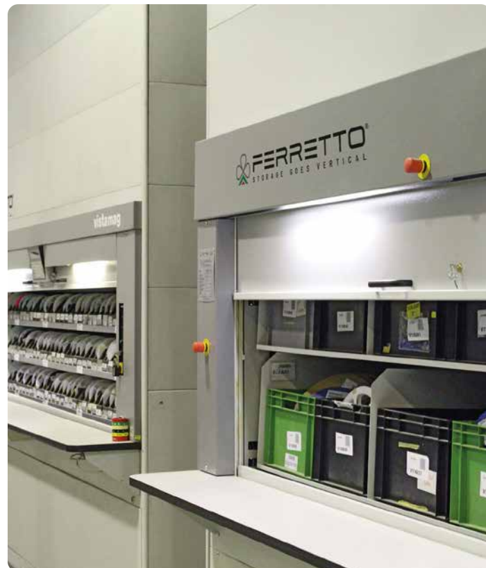
Almacenes rotativos industriales para el almacenamiento de componentes de circuitos integrados
