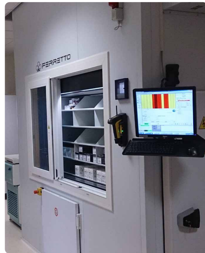
Magazzini rotanti a temperatura controllata (Settore Ospedaliero)
