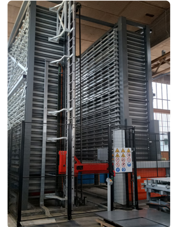
Entrepôt automatique pour le stockage de tôles sur le plateau
