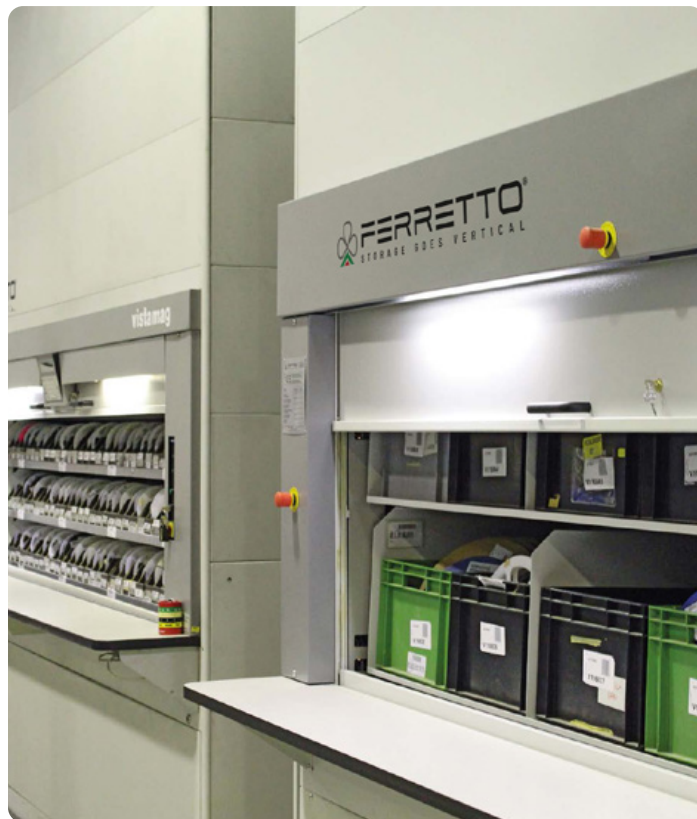
Entrepôts rotatifs industriels pour le stockage de composants de circuits intégrés
