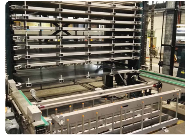
Entrepôt automatique vertical pour tôles Steel Tower (industrie sidérurgique)
