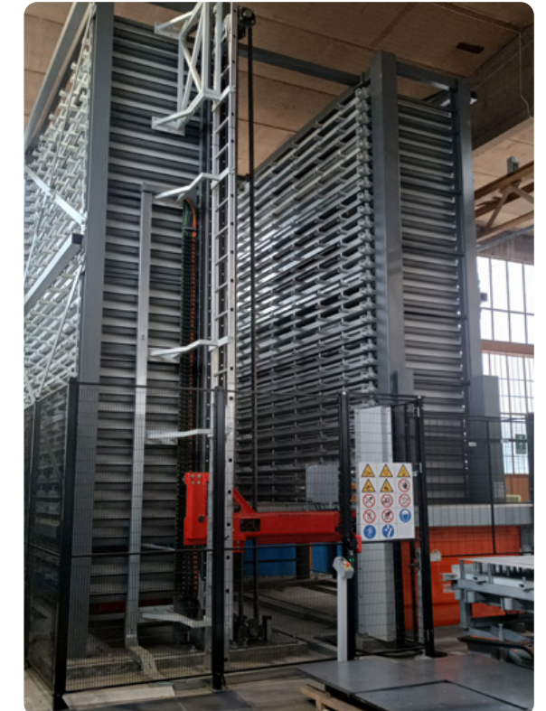
Almacén automático para almacenamiento de chapas en bandejas
