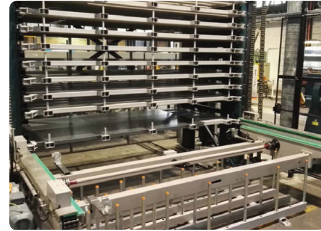
Almacén automático vertical para chapas Steel Tower (sector siderúrgico)
