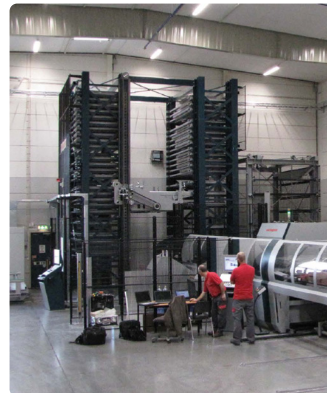
Almacén automático para almacenamiento de paquetes de chapas en bandejas (sector mecánico)
