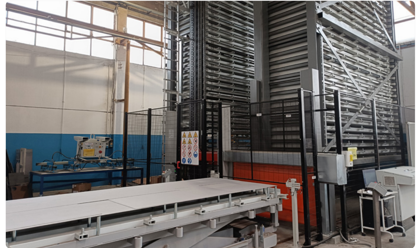
Almacenes automáticos verticales para barras y chapas Steel Tower
