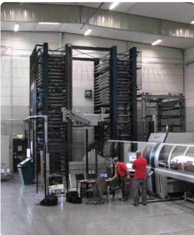
Entrepôt automatique pour le stockage de paquets de tôle sur le plateau (industrie mécanique)
