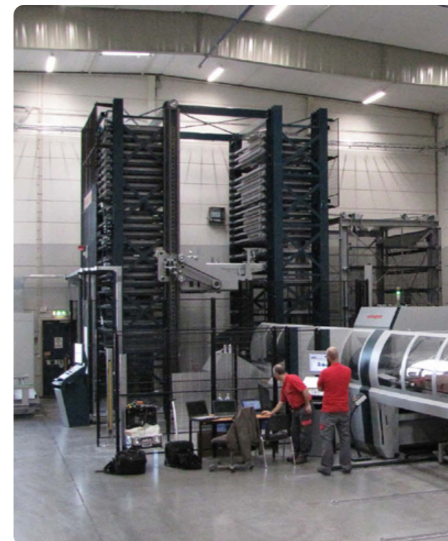
Magazzino automatico per stoccaggio pacchi di lamiera su vassoio (sette meccanico)
