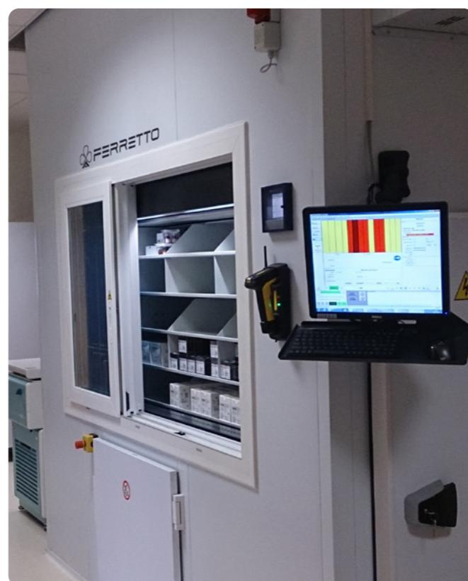
Magazzini rotanti a temperatura controllata
