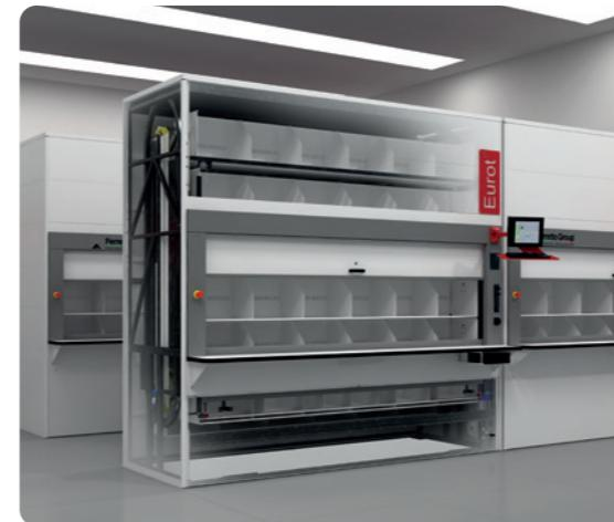
Sistema automatico verticale rotante per lo stoccaggio ed il picking.
