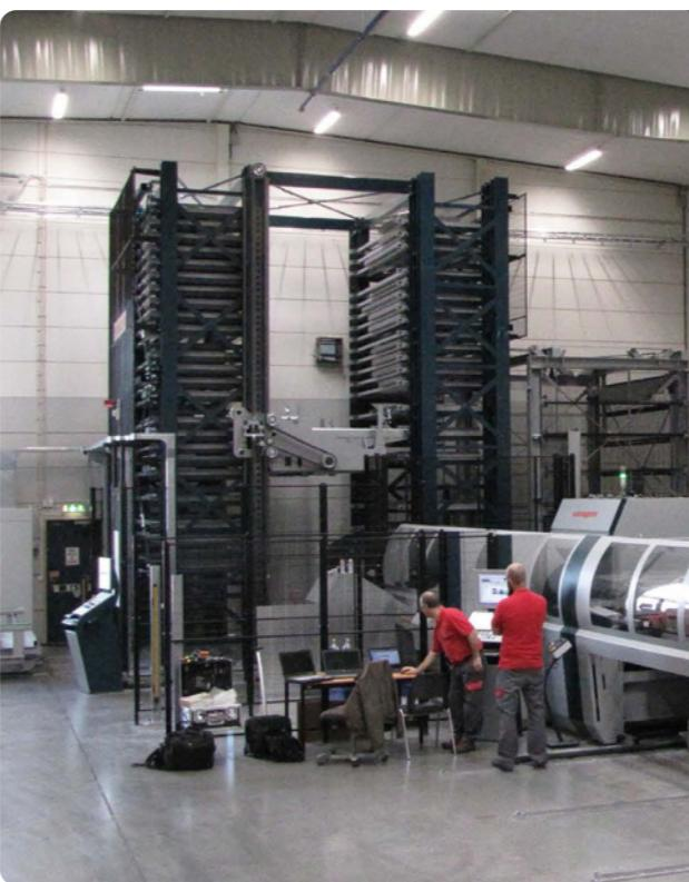
Magazzino automatico per stoccaggio pacchi di lamiera su vassoio (settore meccanico)
