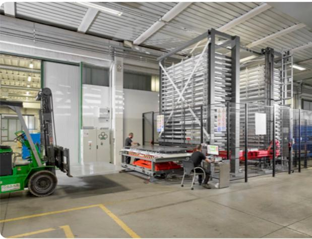
Magazzino automatico verticale per lamiera Steel Tower (settore siderurgico)
