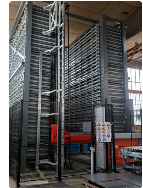
Magazzino automatico per stoccaggio lamiere su vassoio
